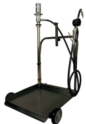
B.49.02.0002 Trolley unit for 200 litres drums. With digital litre-counter. Compression ratio 3:1. Unità mobile per fusti 200 litri. Con contaltri digitale. Rapporto di compressione 3:1.
